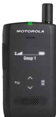
O rádio TETRA compacto ST7000 supera essas necessidades com o seu formato pequeno e elegante, interface de usuário simples e áudio claro. Com um sistema de antena híbrido - com antena interna e externa, o ST7000 é discreto e cabe perfeitamente em qualquer bolso. Os botões sensíveis ao tato, a tecnologia sem fio Bluetooth® 4.0, o conector USB-C reversível para carga e o conector de áudio de 3,5 mm fazem do ST7000 um rádio TETRA moderno e flexível.
